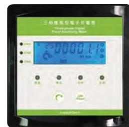
TPM三相電子式電表，具有寬量程全數位電能及電量測量功能，可設定成三相三線或三相四線及單相三線供電系統之專用電子式電表，可測量實功瓦特(W)、瓦時(Wh)、虛功乏(VAR)、乏時(VARh)，及各相之電壓(V)、電流(A)、功率因數(PF)及頻率(Hz)等。
